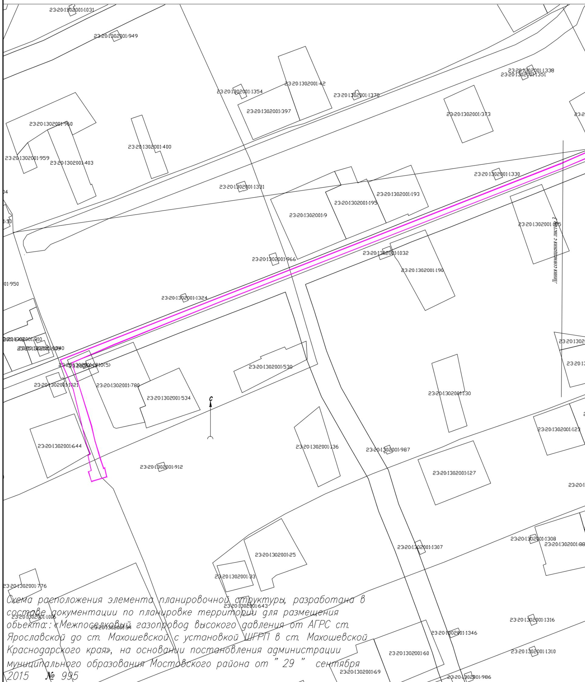
Схема расположения элемента планировочной структуры, разработана в составе документации по планировке территории для размещения объекта: «Межпоселковый газопровод высокого давления от АГРС ст. Ярославской до ст. Махшевской с установкой ШГРП в ст. Махшевской Краснодарского края», на основании постановления администрации муниципального образования Мостовского района от " 29 " сентября 2015 № 995
