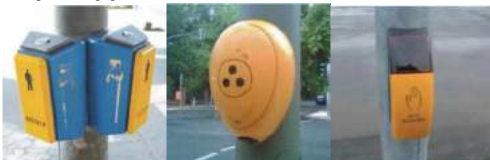
Рисунок 4.16.6 – Пример осязательного сигнала пешеходного перехода
