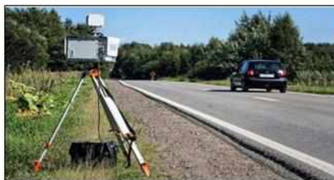
Рисунок 4.19.1 – Примеры установки комплексов фотовидеофиксации Система фотовидеофиксации нарушений ПДД дополнительно может быть использована для:
