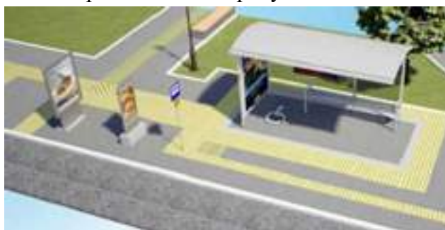
Рисунок 4.16.13 – Предложения по расположению тактильной плитки на остановочном пункте
