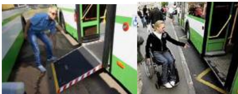
Рисунок 4.16.7 – Зазор между транспортным средством и бортовым камнем остановочного пункта
