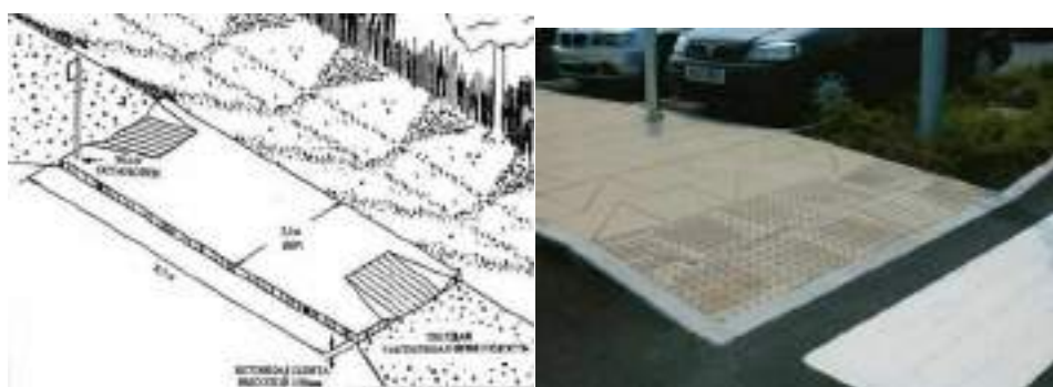
Рисунок 4.16.11– Пример оборудования посадочной площадки пандусами
